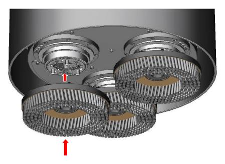
Über den Fusstaster unten an der Maschinenverschalung, kann das automatische Schnellspann-System ausgelöst werden. Eine einfache und schnelle Art, beidhändig den Werkzeugwechsel vorzunehmen.
